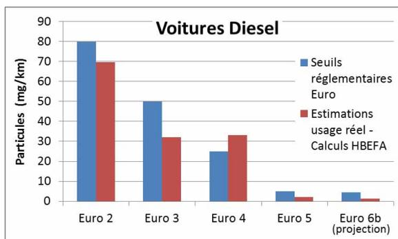
Comparaison entre les seuils réglementaires Euro et les émissions calculées en usage réel suivant la méthode HBEFA<sup>17</sup>, de l'évolution dans le temps des émissions à l'échappement de particules primaires des voitures Diesel.
