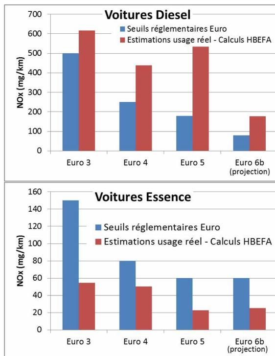
Comparaison entre les seuils réglementaires Euro<sup>18</sup> et les émissions calculées en usage réel suivant la méthode HBEFA<sup>17</sup>, de l'évolution dans le temps des émissions de NOx des voitures Diesel et essence.
